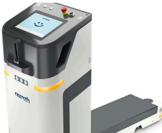
Touchscreen-Display und 3D Hinderniserkennung: Das neue ActiveShuttle mit Advanced Interaction transportiert Kleinladungsträger autonom, sicher und hochflexibel. (Bildquelle: Bosch Rexroth AG)
