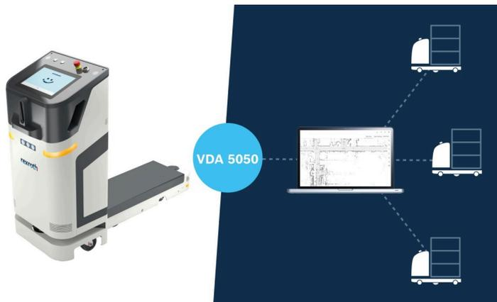
Der autonome mobile Roboter ACTIVE Shuttle ist durch normierte Schnittstellen wie die VDA 5050 zukunftssicher und flexibel einsetzbar. (Bildquelle: Bosch Rexroth AG)
