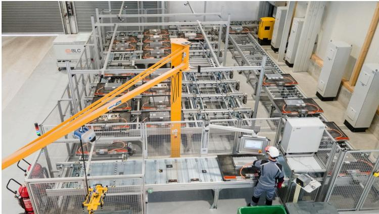
Bosch Rexroth liefert BLC – The Battery Lifecycle Company eine der ersten automatisierten Anlagen zu Entladung und Demontage von Batteriemodulen in Europa. (Bildquelle: Bosch Rexroth AG)
