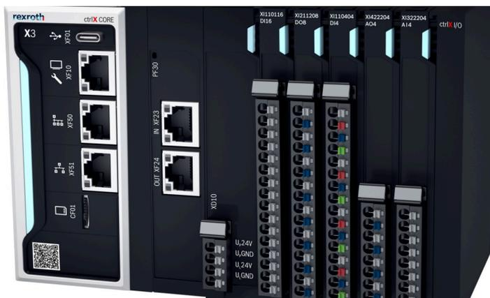
Die neue Steuerungshardware ctrlX COREplus bietet neben erweiterten Feldbus-Schnittstellen die Möglichkeit, I/O Module anzureihen. (Bildquelle: Bosch Rexroth AG)
