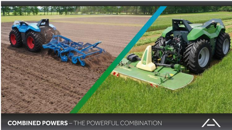
In der Verfahrenstechnischen Einheit (VTE) von KRONE und LEMKEN sind leistungsstarke Motoren und weitere Komponenten der modularen eLION Plattform im Einsatz, um verschiedenste Arbeitsprozesse optimal umzusetzen. (Bildquelle: Maschinenfabrik Bernard KRONE GmbH & Co.)
