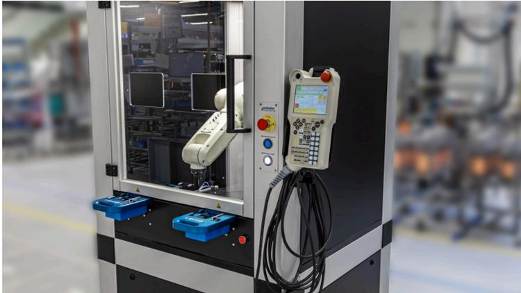
Flexibel und wirtschaftlich: Mit den funktionsintegrierten Profilen von Bosch Rexroth realisiert Kaiser engineering Maschinenumhausungen für Roboterzellen (Bildquelle: Kaiser engineering GmbH)
