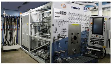
Mit dem neuen Rexroth-Teststand verkürzt die TPH group GmbH die Reparaturzeiten für elektronifizierte Pumpen. (Bildquelle: TPH group GmbH)
