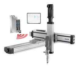
Neues Lösungspaket der Smart MechatroniX Plattform: das universell einsetzbare Smart Function Kit Dispensing, hier mit einem voll integrierten Dosierkopf des Herstellers ViscoTec. (Bildquelle: Bosch Rexroth AG)
