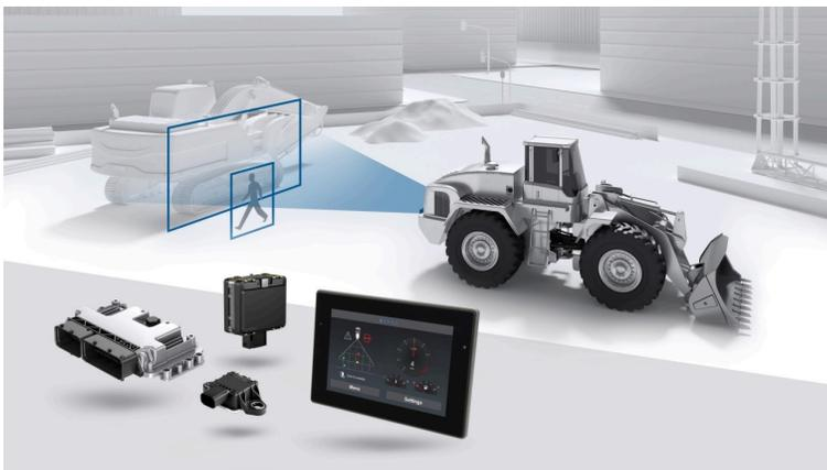
Erhöhte Sicherheit für Off-Highway-Fahrzeuge: Die modulare Lösung von Bosch Rexroth mit offenen CAN-Schnittstellen verkürzt die Markteinführung eines radarbasierten Kollisionsschutzes. (Bildquelle: Bosch Rexroth AG)
