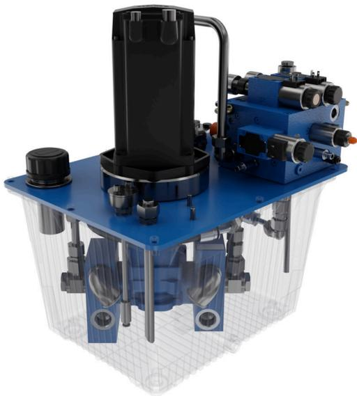
Pumpengeregelt oder ventilgesteuert? Mit zwei neuen Antriebslösungen von Bosch Rexroth lassen sich energieeffiziente Abkantpressen für unterschiedliche Anwendungen wirtschaftlicher konstruieren und modernisieren. (Bildquelle: Bosch Rexroth AG)
