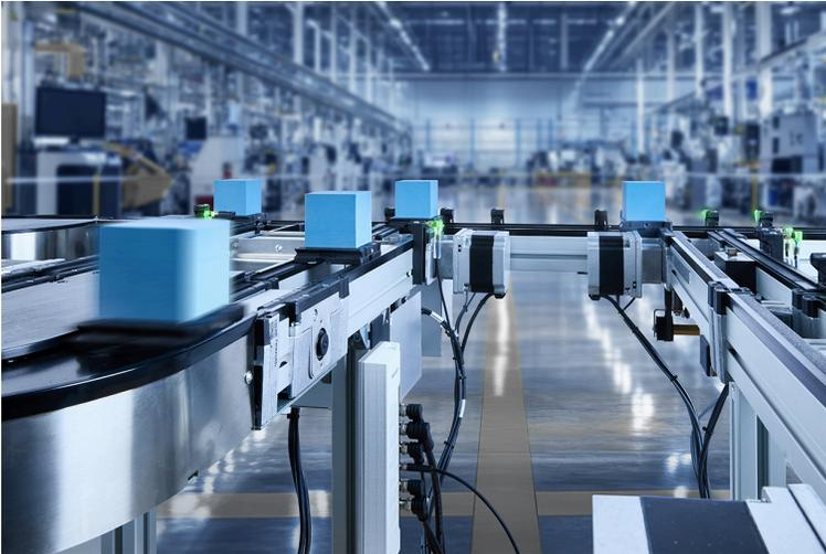
Das Transfersystem TS 1 mit kompakten 48 Volt Schrittmotoren ermöglicht kompakte Anlagenlayouts. (Bildquelle: Bosch Rexroth AG)
