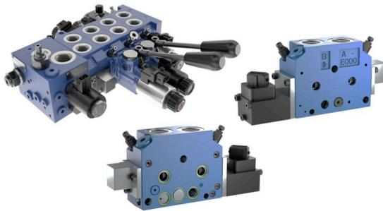
Die vorgesteuerten Ventile EDG von Bosch Rexroth regeln Durchflüsse am Arbeitsanschluss von bis zu 60 l/min (15,8 US gal/min) und Drücke am Arbeitsanschluss von bis zu 350 bar (5076 psi). (Bildquelle: Bosch Rexroth AG)
