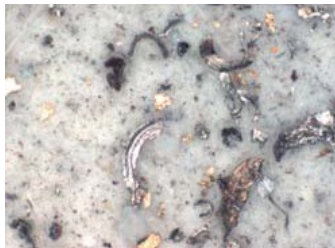
◀ Desgaste por cisalhamento, 500 x
