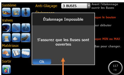
Toutes le buses doivent être ouvertes pour la calibration
