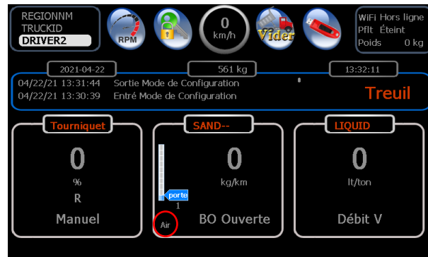
Bascule entre le matériau 1 er ↔ 3 e & position calibrée de la porte
