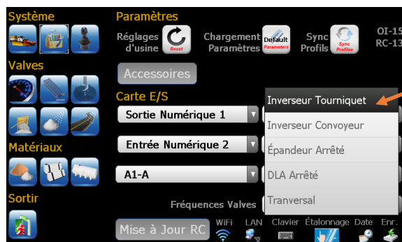
Une entrée « DigIn » sélectionnée (Boite de jonction ou Carte CANIO)
