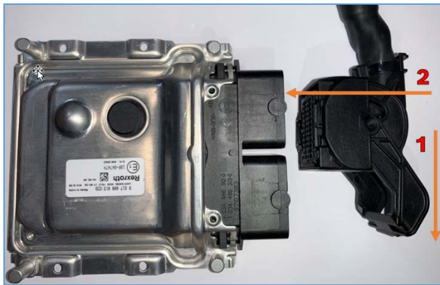
1- Ouverture du loquet – 2- Branchement
