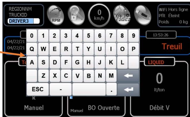
**[6] Poids de la charge** – Ceci affiche le poids mesuré ou pesé du matériau solide dans le camion. L'opérateur entre le poids actuel et à mesure que l'épandage est effectué, le poids diminue. Pour entrer le poids, appuyez et maintenez pendant **5 secondes** votre doigt sur le poids et un clavier apparaîtra:
