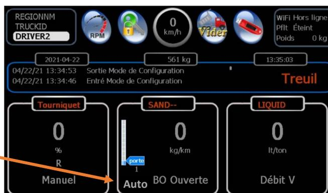
En cas de besoin de déplacer la porte manuellement en raison d'un blocage ou pour une autre raison, l'opérateur peut appuyer sur la barre de la porte à l'écran pour faire apparaître les flèches haut / bas, ajuster à la position souhaitée et appuyer à nouveau sur la barre pour faire disparaître les flèches et confirmer votre choix.
