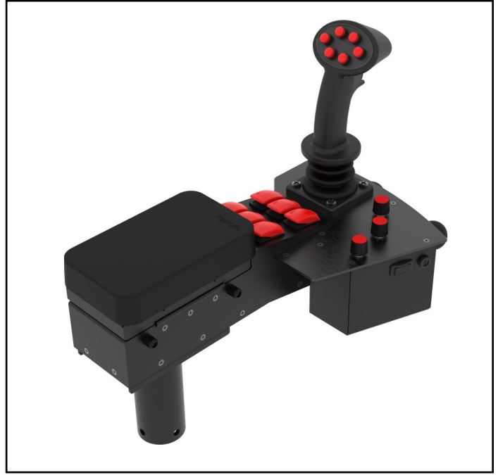
Console Joystick CS-151-551 , de type CANbus @ 6 fonctions, 3 boutons de contrôle d'épandage, peut accueillir jusqu'à 12 interrupteur pour des fonctions secondaires, avec appuis bras rembourré avec penture
