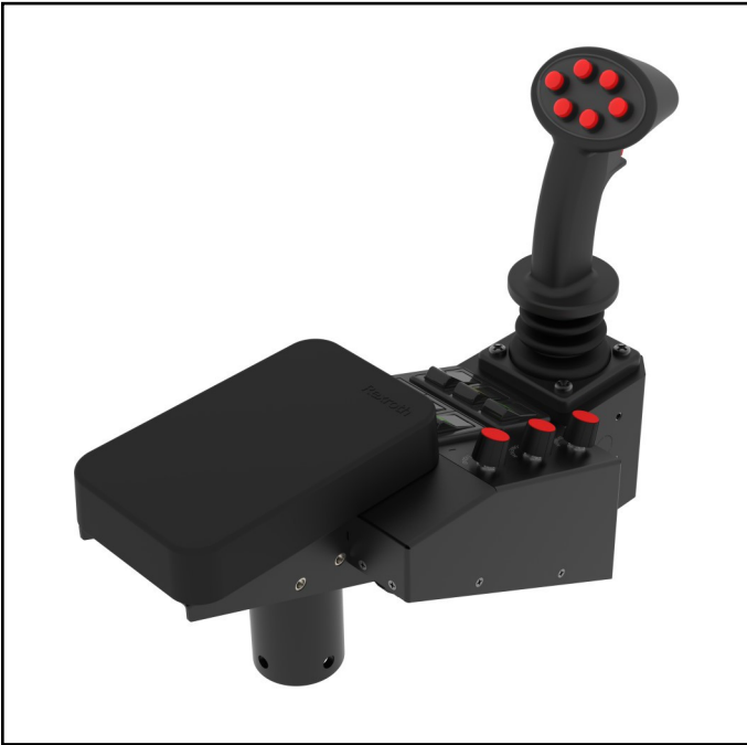
Console Joystick CS-150-551 , de type CANbus @ 6 fonctions, 3 boutons de contrôle d'épandage, peut accueillir jusqu'à 6 interrupteurs pour des fonctions secondaires, avec appuis rembourré.
