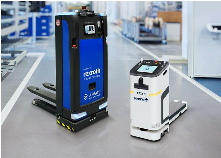
Autonome mobile Roboter wie der ACTIVE Shuttle von Bosch Rexroth und der A-MATE® FreeLift von K.Hartwall können unter der VDA 5050-fähigen Flottensteuerung ACTIVE Fleet Manager gemeinsame Transportaufgaben in der Intralogistik übernehmen. (Bildquelle: Bosch Rexroth AG)
