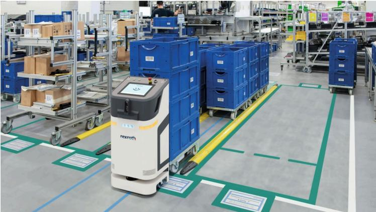
Touchscreen-Display und 3D Hinderniserkennung: Das neue ActiveShuttle mit Advanced Interaction transportiert Kleinladungsträger autonom, sicher und hochflexibel. (Bildquelle: Bosch Rexroth AG)
