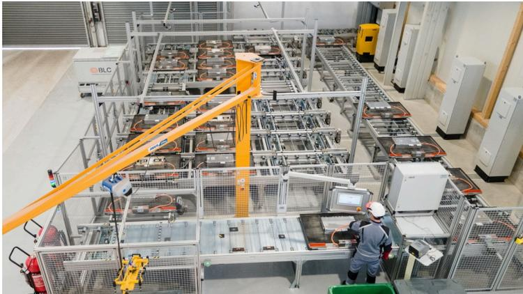
Bosch Rexroth liefert BLC – The Battery Lifecycle Company eine der ersten automatisierten Anlagen zu Entladung und Demontage von Batteriemodulen in Europa. (Bildquelle: Bosch Rexroth AG)
