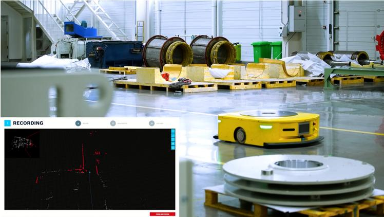
Der modulare Baukasten ROKIT von Bosch Rexroth umfasst Soft- und Hardwarekomponenten für das autonome Fahren verschiedenster Fahrzeugarchitekturen und Größenordnungen. (Bildquelle: Bosch Rexroth AG)
