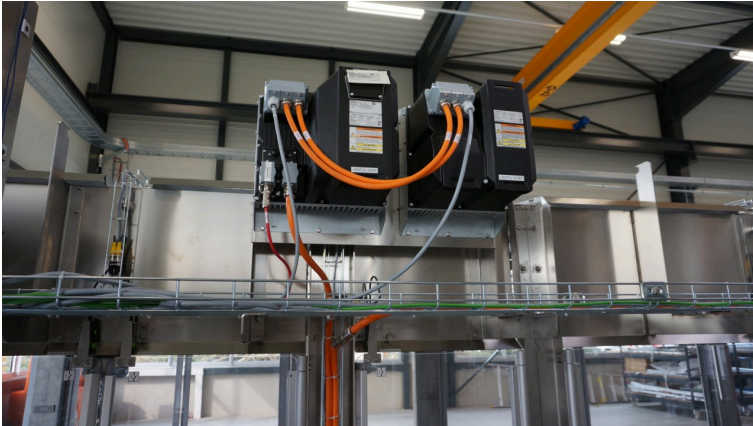
Schaltschranklos: Die dezentrale Antriebslösung IndraDrive Mi ermöglicht eine modulare Bauweise und reduziert den Verkabelungsaufwand durch seriell verlegte Hybridkabel. (Bildquelle: WDS)
