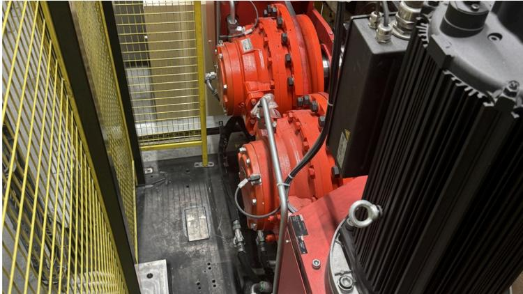
Die beiden Walzantriebe bei Freudenberg Sealing Technologies leisten jeweils 55 kW und nutzen einen Hägglunds CA100 Hydromotor mit einem Nenndrehmoment von 25.000 Nm und einer Nenndrehzahl von bis zu 23 min<sup>-1</sup>. (Bildquelle: Freudenberg Sealing Technologies)
