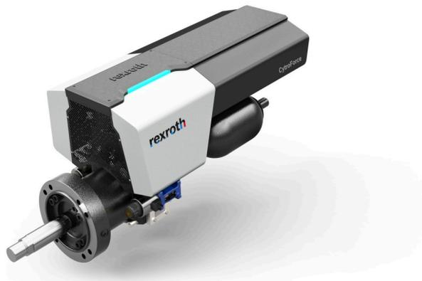
Zusammen mit Tank, Sicherheitsventilen und Sensorik bilden die CytroForce Module eine hochkompakte und effiziente servohydraulische Achse mit geschlossenem Fluidkreislauf, bedarfsabhängiger Stromaufnahme und einheitlichem Antriebs- und Steuerungskonzept. (Bildquelle: Bosch Rexroth AG)
