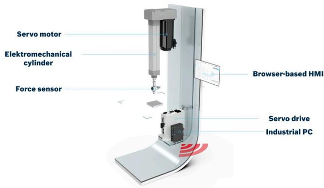
Plug & Produce mit dem Smart Function Kit: Beispiel für smarte mechatronische Lösungen (Bildquelle: Bosch Rexroth AG)
