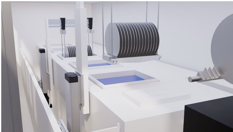
Wafer-Batch-Cleaning mit mechatronischen Mehrachssystem inklusive Motor, Antrieb und Steuerung (Bildquelle: Bosch Rexroth AG)
