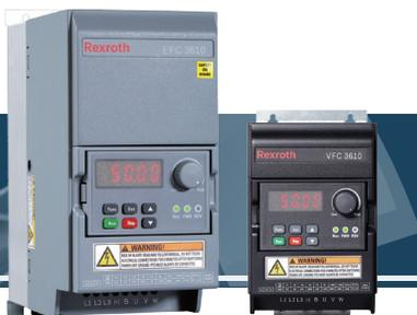
在数控车床应用中，VFC & EFC变频器用来驱动机床主轴，实现无极变速，以满足各种不同加工工艺的要求。通常调速范围从300转到4500转左右，VFC & EFC变频器可达到实际速度误差在±1到2转；在选用开环矢量控制(SVC)下，能够实现很好的动态响应效果，依据负载变化实时调整输出转矩，VFC & EFC 3610启动转矩可达1.5 Hz输出100 %额定转矩；VFC & EFC 5610启动转矩可达0.5 Hz输出200 %额定转矩；同时外接制动电阻来达到快速起停，提高机床加工效率。
