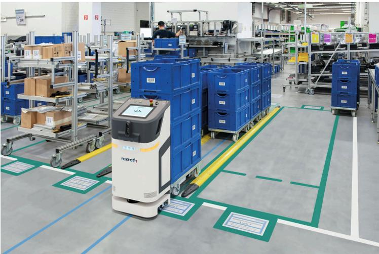
Touchscreen-Display und 3D Hinderniserkennung: Das neue ActiveShuttle mit Advanced Interaction transportiert Kleinladungsträger autonom, sicher und hochflexibel. (Bildquelle: Bosch Rexroth AG)
