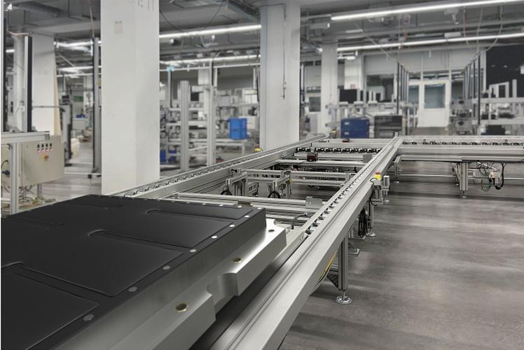
Mit dem neuen Transfersystem TS 7 können Batteriepacks bis weit über eine Tonne sicher und zuverlässig durch die Montage transportiert werden. (Bildquelle: Bosch Rexroth AG)
