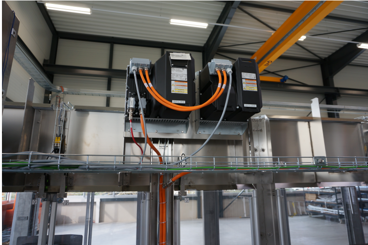
Schaltschranklos: Die dezentrale Antriebslösung IndraDrive Mi ermöglicht eine modulare Bauweise und reduziert den Verkabelungsaufwand durch seriell verlegte Hybridkabel. (Bildquelle: WDS)
