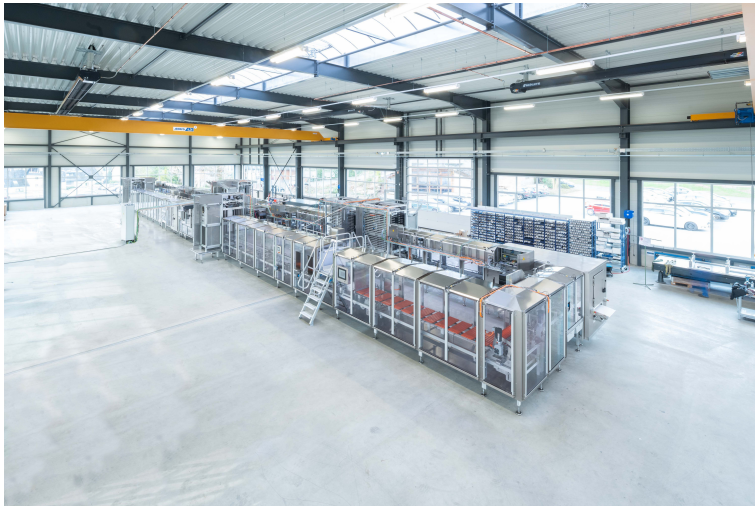
Aufgeräumt und gut zugänglich: die modular aufgebaute ConfecPRO mit dezentraler Antriebstechnik von Bosch Rexroth. (Bildquelle: WDS)
