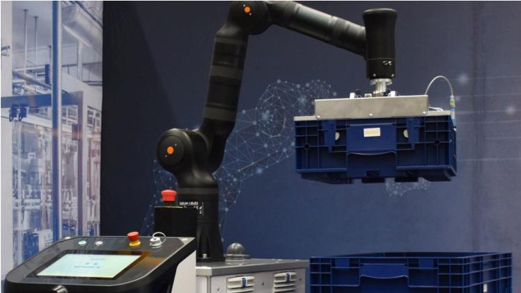
Die Cobot Station wird mit dem AMR ACTIVE Shuttle von Bosch Rexroth an ihren Arbeitsplatz transportiert und erhält Informationen vom Produktionsleitsystem. Dann beginnt der 7-Achsen Leichtbauroboter KR810 autark seine Arbeit. (Bildquelle: HELDELE Automation GmbH)
