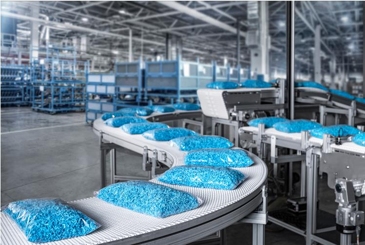
Modulbandförderer VarioFlow belt mit einer sehr engmaschigen, nahezu geschlossenen und ebenen Oberfläche für FMCG- und Pharma/Healthcare-Anwendungen. (Bildquelle: Bosch Rexroth AG)
