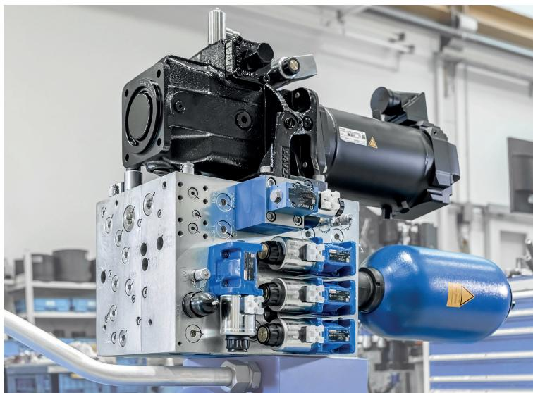
Effiziente Blechumformung: Die servohydraulische Antriebslösung von Bosch Rexroth erhöht die Energieeffizienz von Tiefziehpressen. (Bildquelle: Bosch Rexroth AG)
