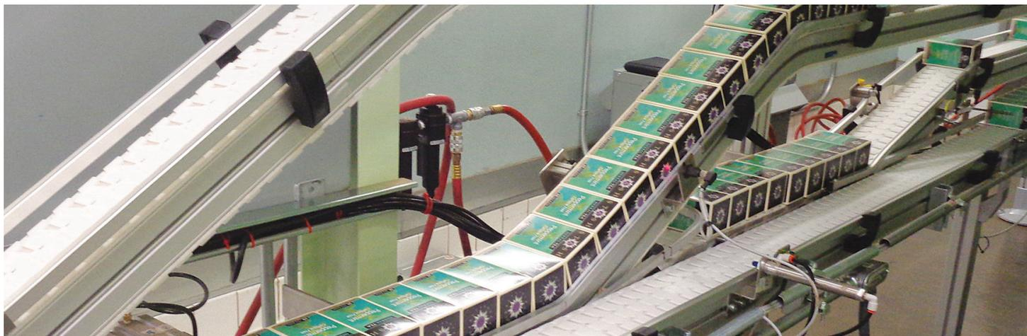
Produzione moderna delle bustine di tè con il sistema di trasporto flessibile VarioFlow *plus* di Bosch Rexroth
