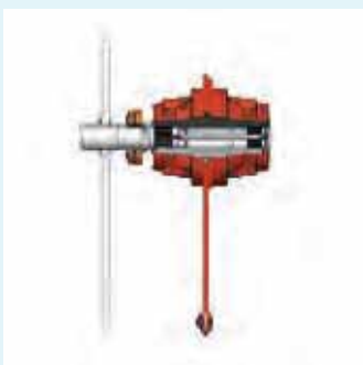
▲ シャフトカップリング付きモータのトルクアーム取り付け
