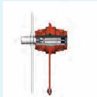
▲ スプラインシャフトモータのトルクアーム取り付け
