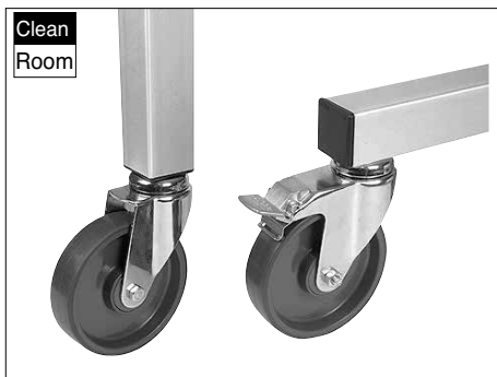
キャスターはグレーPU、ハウジングはクロムメッキ鋼、フロアセービング、クリーンルームに適する、導電性 10^3 - 10^8 \Omega \text{ cm} 、DIN EN 61340-5-1
