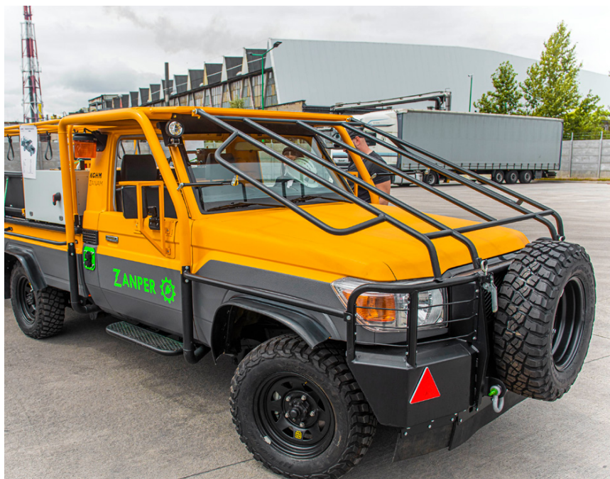
Pojazd elektryczny ZANPER, wyprodukowany przez KGHM ZANAM S.A. oraz wskaźnik przechyłów na pulpicie pojazdu ZANPER źródło: KGHM S.A.
