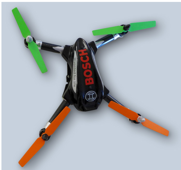
Dron z nawigacją inercyjną (bezwładnościową) opartą o MEMS.
