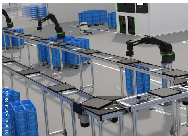
Jedyny na świecie robot wyposażony w zabezpieczenia, które zatrzymują pracę robota, zanim dojdzie do kontaktu z człowiekiem.
