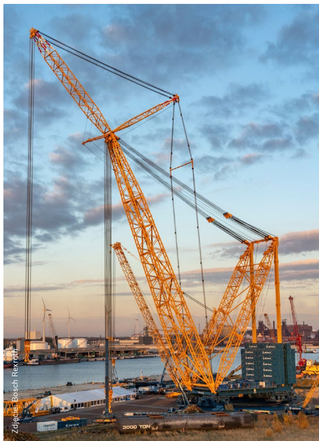
Firma Sarens zbudowała największy na świecie żuraw, w którym pracuje system hydrauliczny SGC-250.
