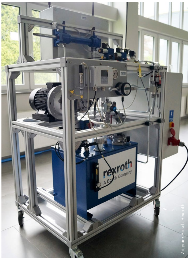
Monitorowany system hydrauliczny realizujący przykładową funkcjonalność ruchu z wykorzystaniem cylindra.
