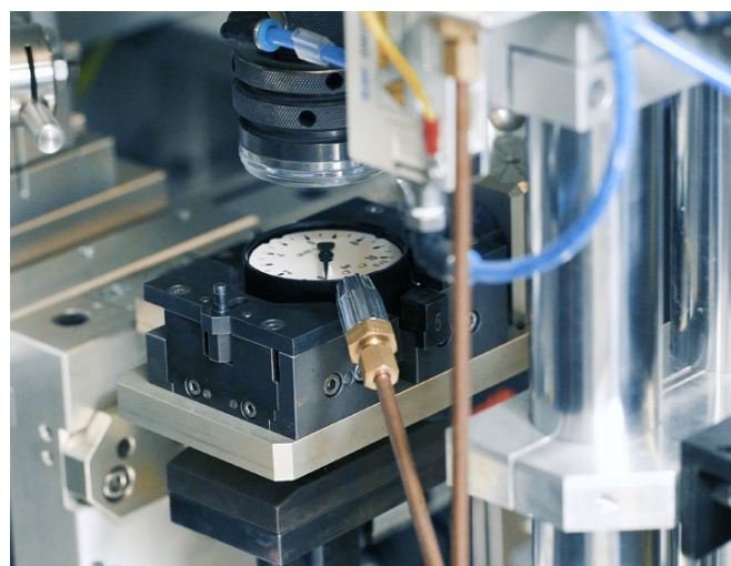
WIKA Polska SGF wytwarza tysiące wariantów manometrów za pomocą systemu Automatic Gauge Assembly (AGA 1) opartego na rozwiązaniu ACTIVE Mover firmy Bosch Rexroth. Skraca on czasy przezbrajania o ponad 50%. (Zdjęcie: Bosch Rexroth AG)
