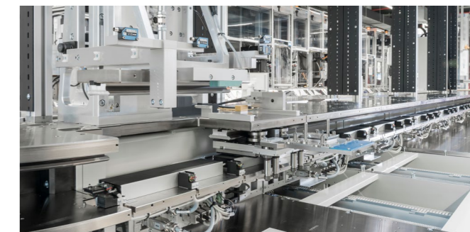
Elastyczny system transportu FTS w sposób bezkontaktowy przeprowadza elementy akumulatora przez komory procesowe. (Źródło ilustracji: Bosch Rexroth AG)
