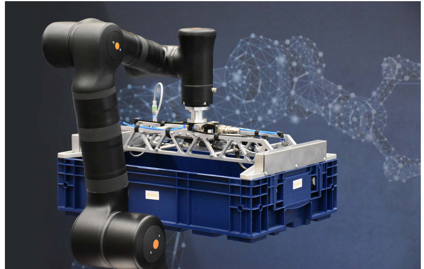
W mobilnej stacji kobotycznej HELDELE można zainstalować każdy z dziesięciu modeli robotów Kassow Robots. (Zdjęcie: HELDELE Automation GmbH)
