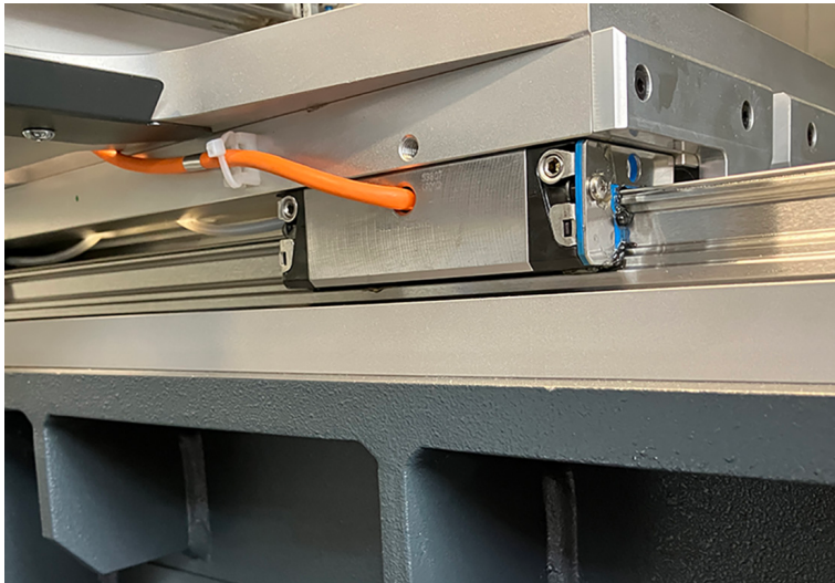
Kompaktowy wózek prowadzący IMScompact ze zintegrowanym enkoderem i interfejsem SSI. Stalowa obudowa chroni magnetyczną metodę pomiaru przed wpływami elektromagnetycznymi. (Źródło obrazu: Bosch Rexroth AG)
