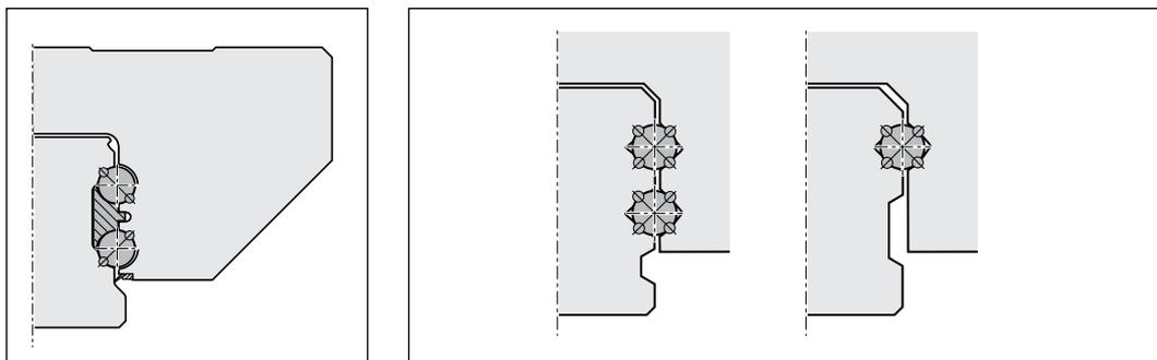
Благодаря конструктивному исполнению шариковых кареток Rexroth, оснащенных 4 рядами шариков, по всем плоскостям приложения нагрузки обеспечивается **2-точечное соприкосновение** шариков. Благодаря этому трение сводится до минимума.
