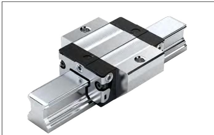
**R1661 ... 2.****Динамические значения**Скорость:  $v_{\max} = 5 \text{ м/с}$ Ускорение:  $a_{\max} = 500 \text{ м/с}^2$ (Если  $F_{\text{comb}} > 2,8 \cdot F_{\text{pr}}$ :  $a_{\max} = 50 \text{ м/с}^2$ )**Указание по смазке**
