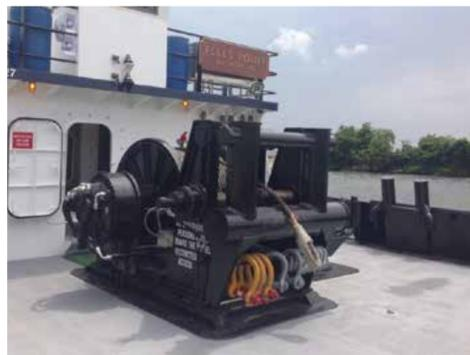
„Bei einem Getriebesystem gibt es keine Möglichkeit des Abbruchs ohne Verwendung zum Beispiel einer Kupplung“, sagt Brandon Durar. „Bei einem Hägglunds-Motor überladen oder fluten wir ihn einfach, schalten den Freilauf ein und schützen so auch den Motor.“
