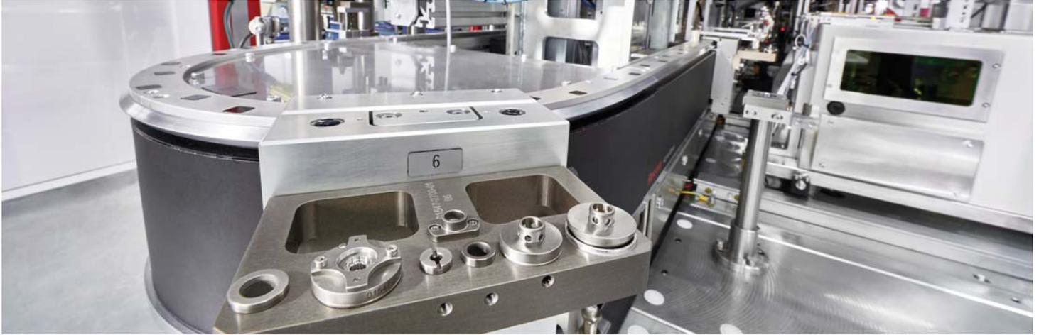
ActiveMover von Rexroth sorgt für kurze Nebenzeiten in einer Montageanlage von Behr Systems
