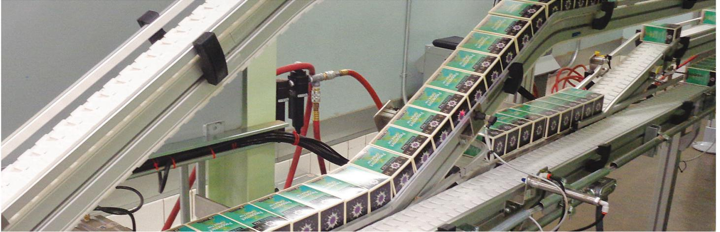
Moderne Produktion von Teebeuteln mit dem flexiblen Fördersystem VarioFlow *plus* von Rexroth
