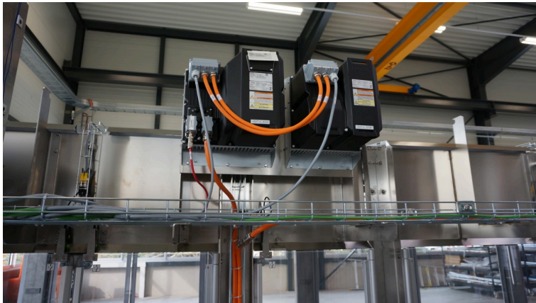
Schaltsschranklos: Die dezentrale Antriebslösung IndraDrive Mi ermöglicht eine modulare Bauweise und reduziert den Verkabelungsaufwand durch seriell verlegte Hybridkabel. (Bildquelle: WDS)
