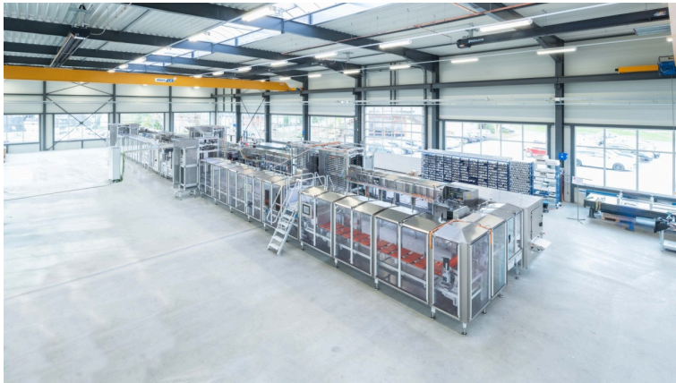
Aufgeräumt und gut zugänglich: die modular aufgebaute ConfecPRO mit dezentraler Antriebstechnik von Bosch Rexroth. (Bildquelle: WDS)
