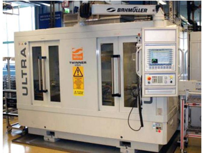
Abb. 100: Innenrundschleifmaschine Ultra Twiner mit zwei Spindeln, hydrostatisch, mit Hochdruckpumpen
