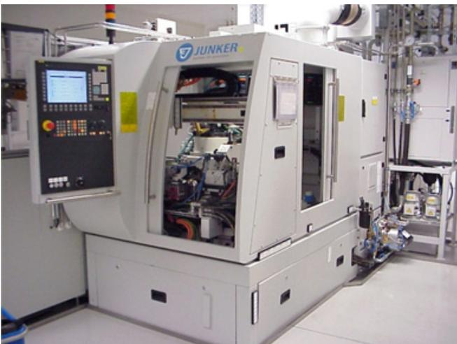
Abb. 99: Außenrundschleifmaschine Jucam 1000/50 mit zwei Spindeln
