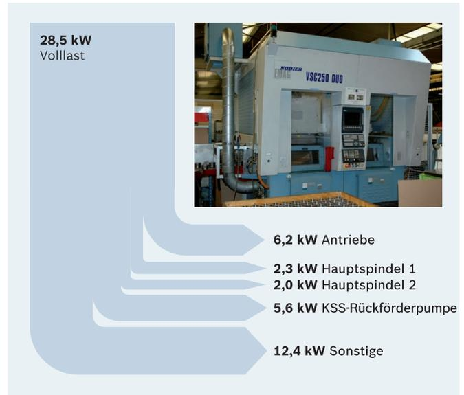
Abb. 97: Drehmaschine VSC250 Duo der EMAG Holding GmbH, Salach
