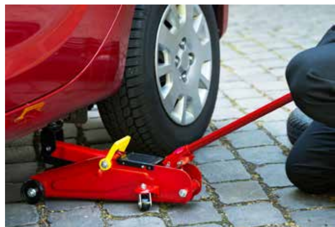
Hydraulischer Wagenheber (Praxisbeispiel für Anwendung der Kraft- und Wegübersetzung)
