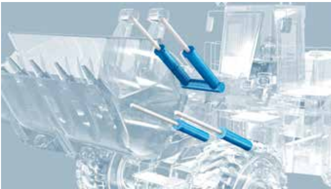
Einsatz von Hydrozylindern in einem Radlader
